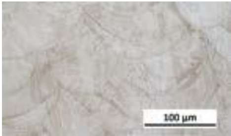
Mikrostruktur nach Bauprozess
